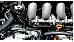
11 Rilsan® HT可取代金属,用来制造发动机零部件,这种聚酰胺耐高温并可减轻发动机重量。该材料的重量是:
