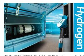
对于车载高 压氢气的存 储(700巴), 现有标准储 罐由热固性( 环氧)树脂复 合材料制成, 经过挠曲工
